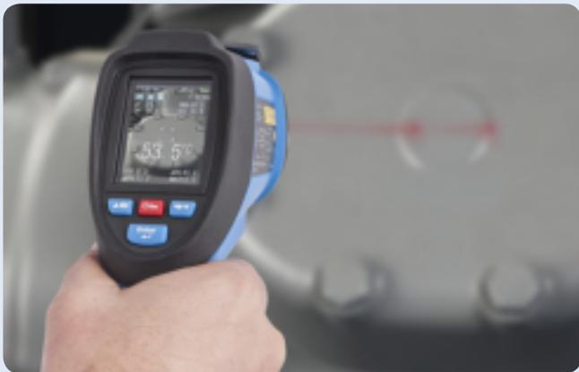
При использовании бесконтактного режима измерений термометр воспринимает тепловую энергию, излучаемую объектом, с помощью инфракрасного детектора. При наведении на объект инфракрасный датчик собирает энергию, производя сигнал, который микропроцессор преобразует в результат измерения, отображаемый на дисплее с подсветкой. При нажатии кнопки инфракрасный датчик измеряет температуру объекта непрерывно. Это обеспечивает быстрое и точное измерение в режиме реального времени.
